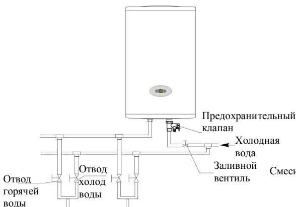
Схема подключения на несколько потребителей
